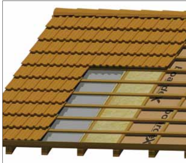
(!) 15 mm kalınlıktaki BoadeX roof için taşıyıcı sistem aks aralıkları 40 cm'dir. Üzerine kaplanacak kaplama malzemesi, yüzeye gelecek kar vb yüklere göre çatı tasarımcıları tarafından hesap yapılarak en fazla 61 cm aks aralığında sabitlenebilir.
